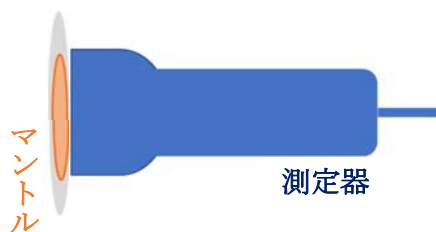
Fig. 2：マントル測定の線源と測定器の配置
