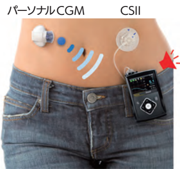
図1 パーソナルCGM機能搭載インスリンポンプ
